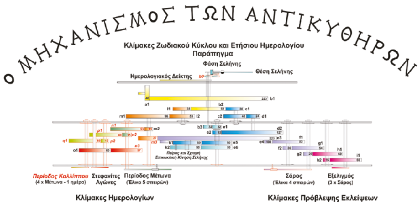
Εικ. 3. Η διάταξη των οδοντωτών τροχών (γρανάζιων) του Μηχανισμού των Αντικυθέρων (Αναστασίου, Σειραδάκης Προσαρμογή από Freeth T.).
